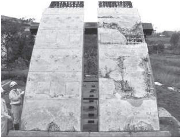
図-4 試験施工結果 (スランプ：左15cm、右8cm)
