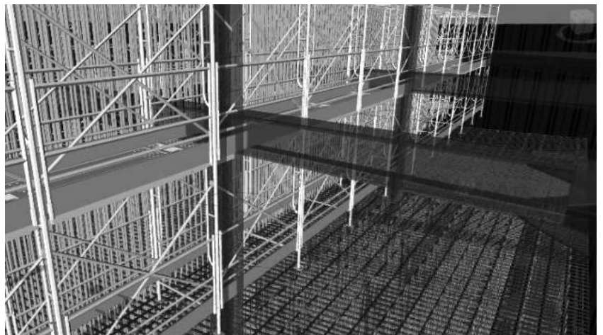
図-6 鉄筋と切梁材の干渉チェック
