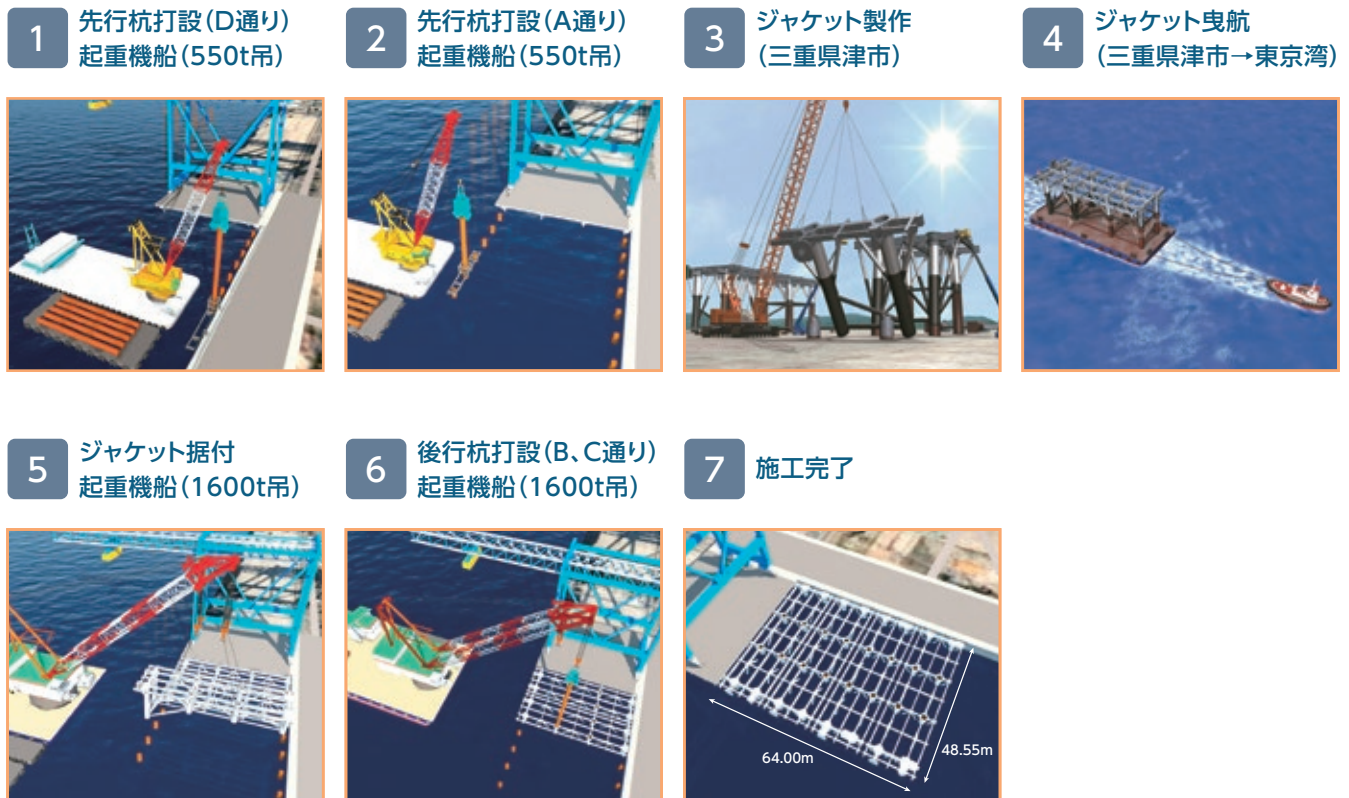
【図-4】 施工順序図
