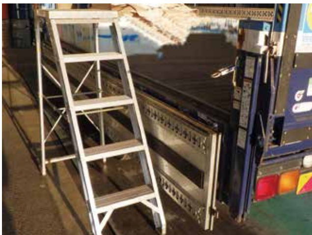
（図表5）荷台への昇降設備
