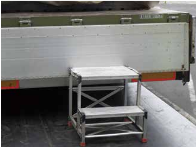
（図表4）不適切な昇降設備
