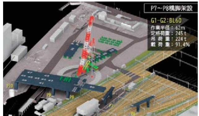
【図-9】 P7~P8間 大ブロック桁架設
