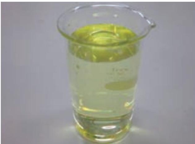
写真-1 亜硝酸リチウム水溶液の外観
