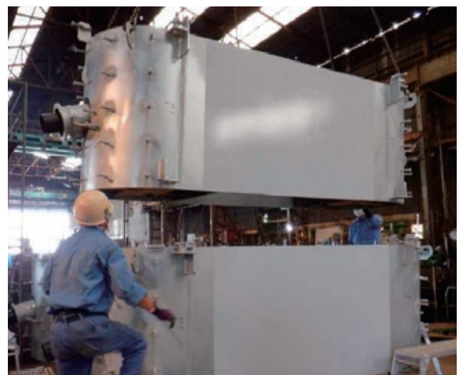
【写-8】小判形鋼板の施工性試験および仮組検査
